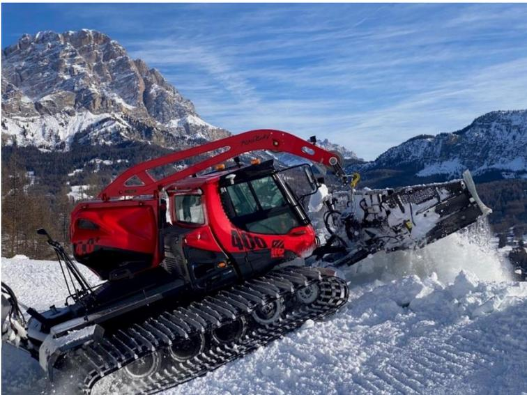
Der PistenBully 400 ParkPro – ausgestattet mit einer 6-Band-KomibPlus-Kette mit STEP-G-Aluminiumprofilen.
